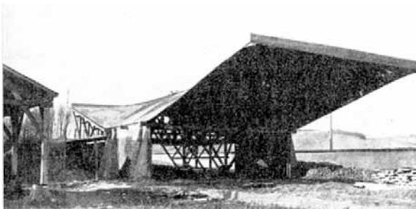
Le misure sono affidate al laboratorio dell'Ecole des Ponts et Chaussées di Parigi, con l'impiego di apparecchiature d'avanguardia (fotoelasticità di Mabboux, corde vibranti di Coyne). Le prove dureranno per più di un anno.
